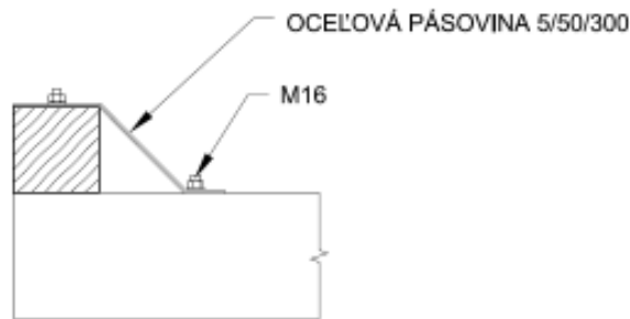
Obr. Zabezpečenie spoja okapovej väznice k väznému trámu
